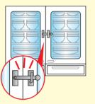
チェーンと金具 を使って数箇所止 める。蛍光灯は蛍光 管の両端を耐熱テ
